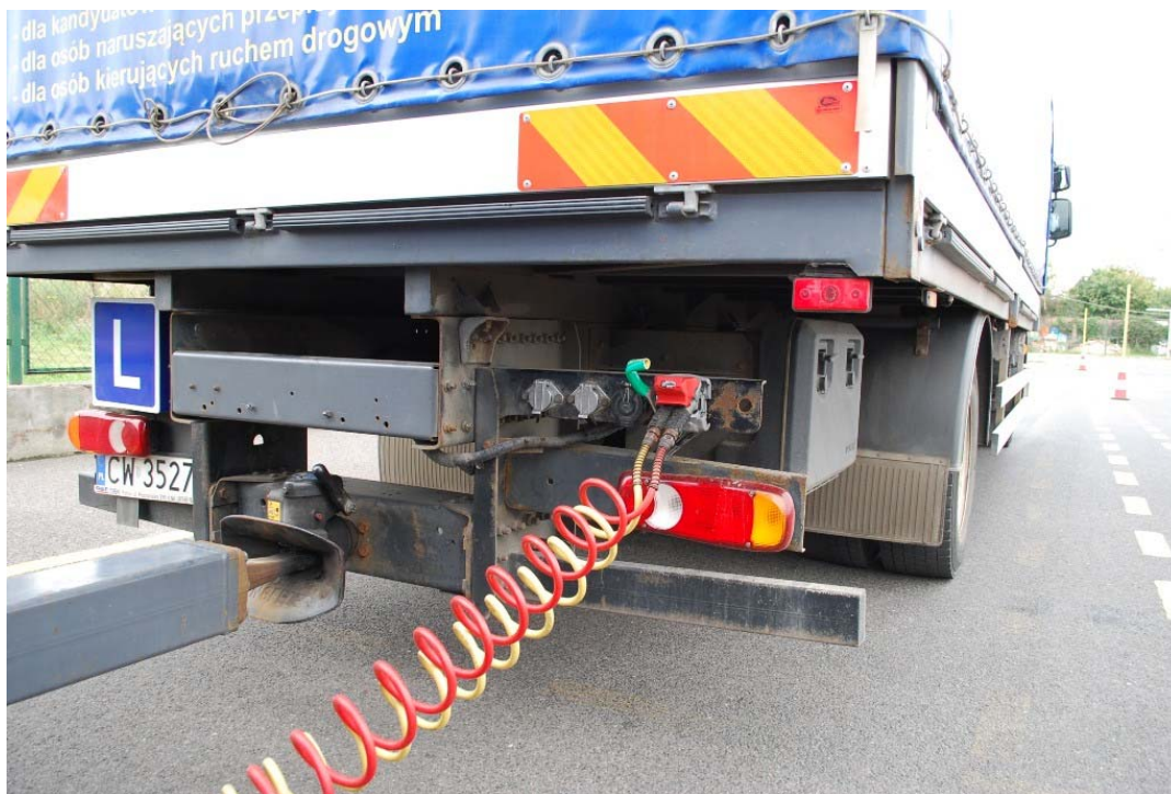
Podłączone złącze pneumatyczne
